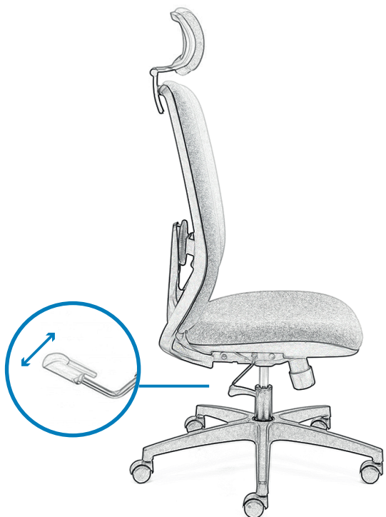
EN Synchronized adjustment of the tilt angle of the backrest and seat using the right lever FR Inclinaison synchronisée du dossier et de l'assise avec le levier droit PL Synchroniczne odchylenie oparcia i siedziska prawą dźwignią
