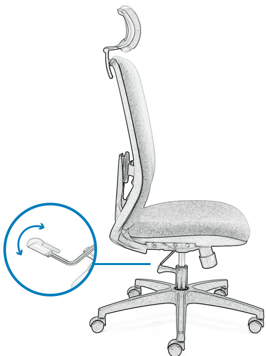
EN Seat height adjustment with the right lever FR Réglage de la hauteur de l'assise avec le levier droit PL Regulacja wysokości siedziska za pomocą prawej dźwigni
